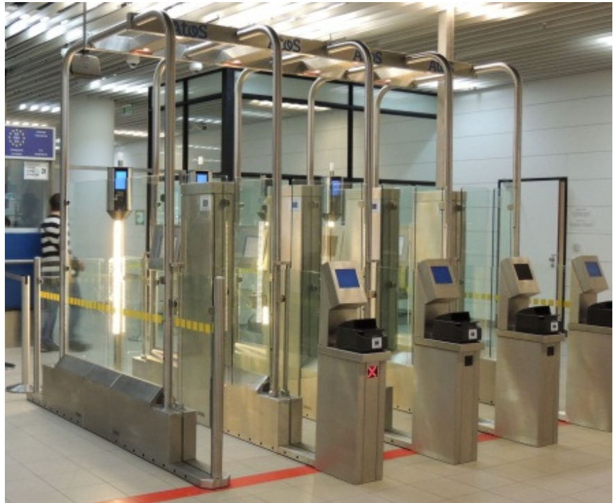
Bild: ABC Speed Gates am Flughafen Sofia mit MODI Facetower, Gate Technologie der Firma Gunnebo und ATOS als Generalunternehmer
